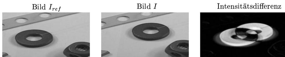
Abbildung 3.11: Unvollständige Detektion bei fehlenden Grauwertdifferenzen
