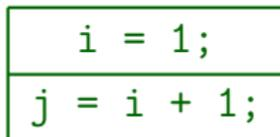
Flussdiagramme sind in DIN 66 001 genormt, Struktogramme in DIN 66 261. Flussdiagramme sind in Verruf geraten, weil sie unstrukturierten Programmen mit beliebigen Sprüngen entsprechen. Sie scheinen mir persönlich aber übersichtlicher zu sein (und zeigen eher, wie die CPU das Programm abarbeitet).
