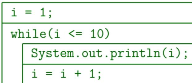
In der Literatur werden für den Schleifenkopf unterschiedliche Notationen verwendet. Manche schreiben z.B. "Solange" oder "DO" anstelle von "while" und lassen die Klammern weg. Manche geben auch nur die Schleifenbedingung an. Da das gleiche graphische Symbol auch für die for-Schleife verwendet wird, ist dies aber etwas problematisch.
