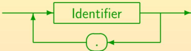
Wenn "PackageOrTypeName" verwendet wird, ist syntaktisch nur klar, dass sowohl ein Paket-Name wie ein Typ-Name (z.B. Klasse) möglich wäre. Beides ist einfach eine Folge von Bezeichnern ("Identifier"). In der Java Spezifikation [<http://docs.oracle.com/javase/specs/jls/se7/jls7.pdf>] gibt es dann Regeln, um eventuelle Mehrdeutigkeiten aufzulösen (Abschnitt 6.5.4).
